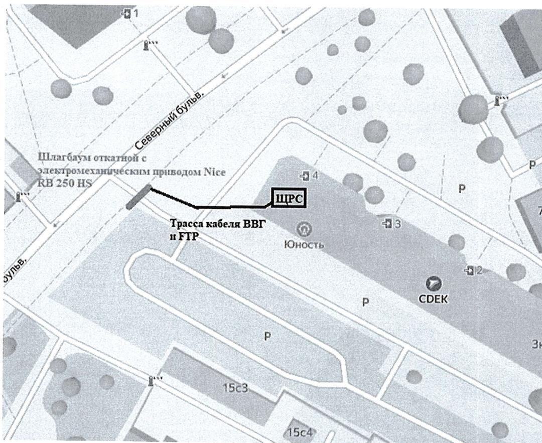
Установка одного автоматического откатного шлагбаума с электромеханическим приводом NICE RB 250 HS
